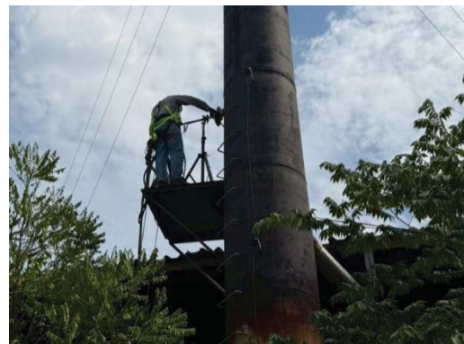
ภาพที่ 3.2.3-1 แสดงการตรวจวัดคุณภาพอากาศในปล่องเตาเผาขยะ
